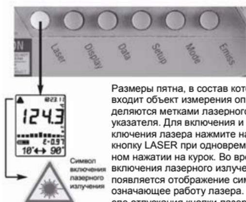
Размеры пятна, в состав которого входит объект измерения определяются метками лазерного указателя. Для включения и выключения лазера нажмите на кнопку LASER при одновременном нажатии на курок. Во время включения лазерного излучения появляется отображение символа означающее работу лазера. После отпускания кнопки лазер автоматически отключается.
